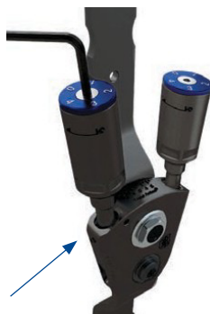
Figur 3: Lossa ROM-vredets skruv med 2 mm nyckel och nollställ inställningen genom att vrida det blå ROM-vredet. ROM-låsskruven används som referens (Figur 3a och 3b).
